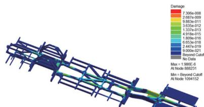
c) 急转弯工况损伤云图与寿命云图
