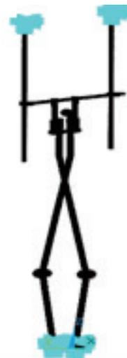
图 2 隔离开关的有限元模型
