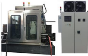
图4 电解加工机床与斩波系统
