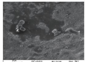
图 6 拉杆腐蚀坑电镜扫描图
