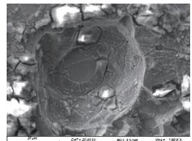
图 4 定距管腐蚀坑内部电镜扫描图
