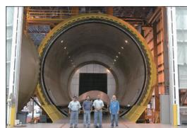
图 13 用于 B787 机身固化的全球最大热压罐
