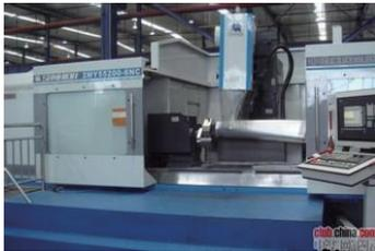
图 12 叶片七轴六联动数控高效精密砂带磨
