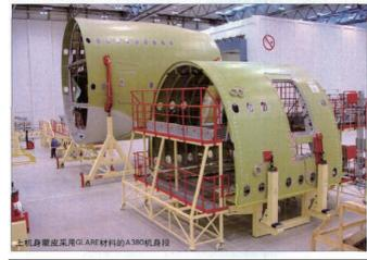
图8 采用 CLARE 材料的 A380 机身段
