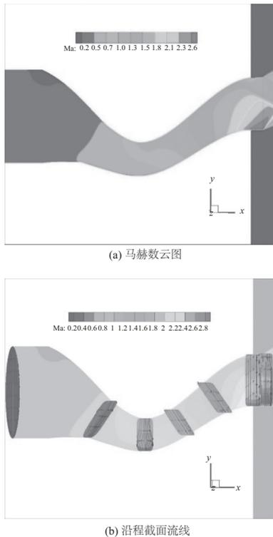
图 5 NPR=6, 单涵道 S 弯喷管中心截面马赫数、沿程截面流线
