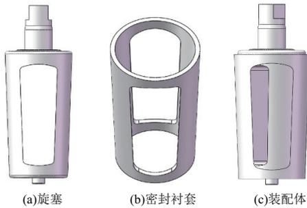
图1 旋塞与密封衬套零件模型与装配体
