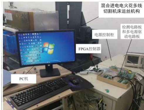
图9 混合进电电火花多线切割机床实物图
