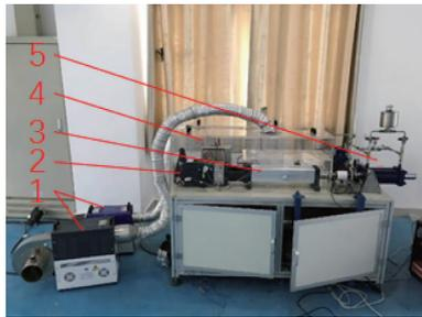
1—热风机;2—永磁电机;3—电缸;4—伺服驱动器;5—液压缸。
