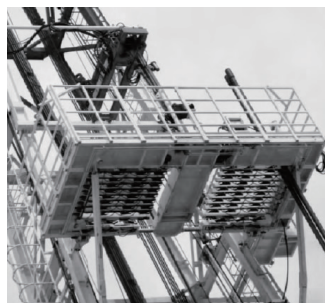
图4 二层台机械手和弹簧指梁
