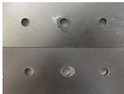
图6 孔失效位置 ( 1^\# 、 3^\# 钉-孔间隙 160 \mu\text{m} )
