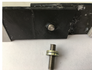
图4 单钉单剪连接螺栓剪切失效 ( 18 \text{ N} \cdot \text{m} 拧紧力矩)
