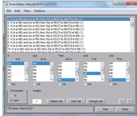
图 5 模糊规则编辑器  $\Delta K_p$ 、 $\Delta K_I$ 、 $\Delta K_D$  中的控制规则
