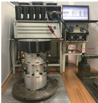
图 13 飞轮电池试验系统实物图
