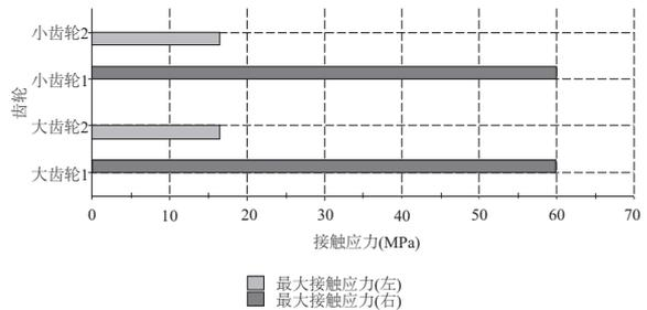
图 4 修形前最大接触应力图
