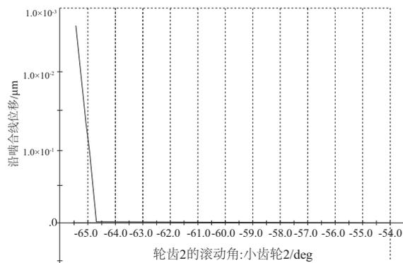
图 12 修形后小齿轮 2 和大齿轮 2 啮合传动误差图
