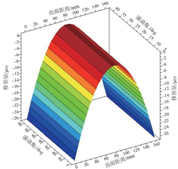
图 8 修形后小齿轮 1 轮齿载荷图
