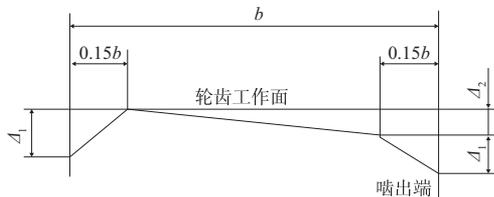
图 7 小齿轮 1 齿向修形曲线
