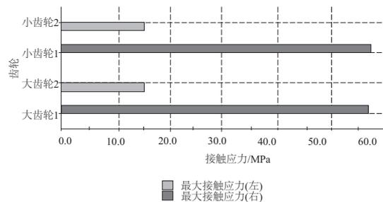
图 10 修形后最大接触应力
