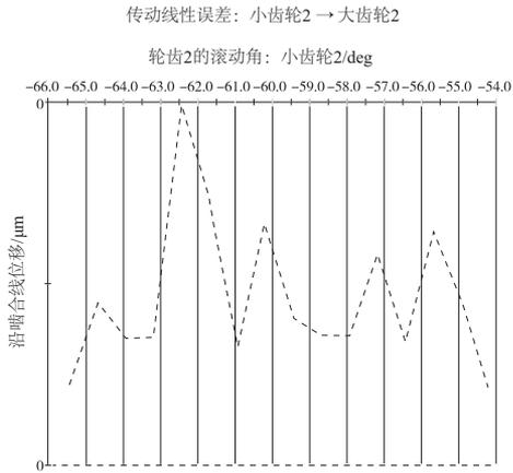
图 6 修形前小齿轮 2 和大齿轮 2 啮合传动误差图
