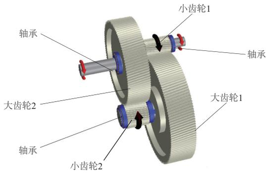
图 1 完整的二级斜齿轮传动系统
