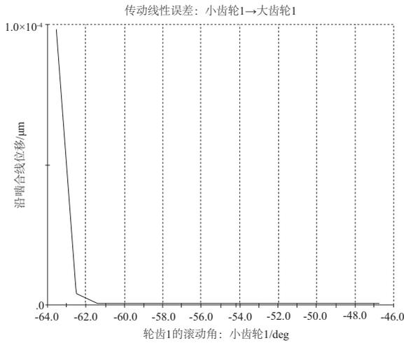
图 11 修形后小齿轮 1 和大齿轮 1 啮合传动误差图
