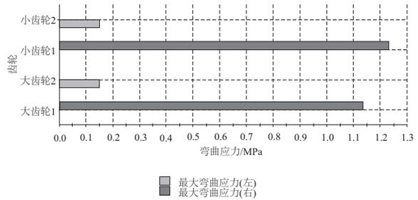
图 3 修形前最大弯曲应力图
