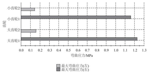
图 9 修形后最大弯曲应力
