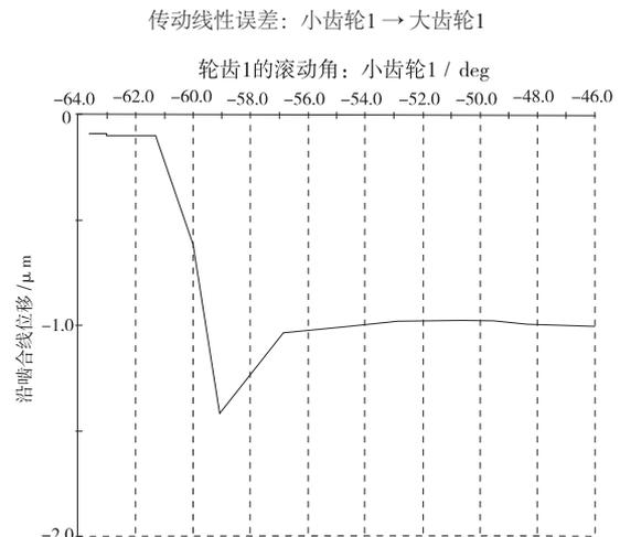
图 5 修形前小齿轮 1 和大齿轮 1 啮合传动误差图
