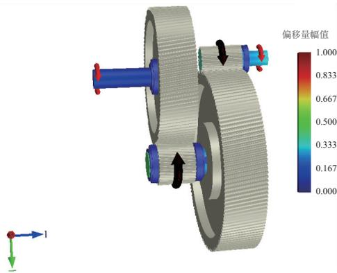
图 2 二级斜齿轮传动系统偏移量总体云图
