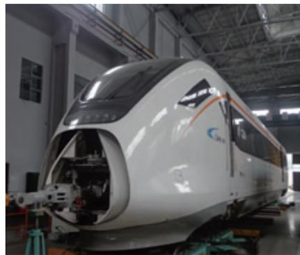
图 7 被试车辆在机车车辆滚动振动试验台上
