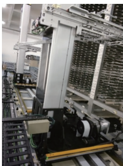
图8 移栽小车现场测试
