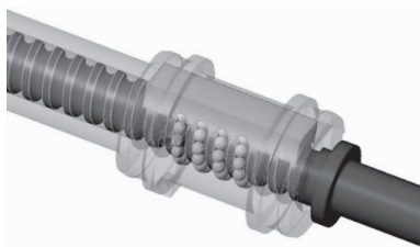
图 1 含矩阵式返向器的滚珠丝杠副模型 (局部)
