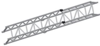
图4 主塔有限元模型
