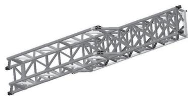
图 8 主塔有限元模型
