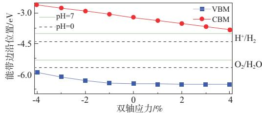
图 6 ZnO/GaN vdW 异质结在 pH=0 和 pH=7 时用于光催化水分解的可调电子性能
