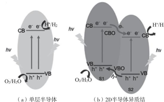
图 4 单层和 2D 异质结为光催化剂分解水的示意图
