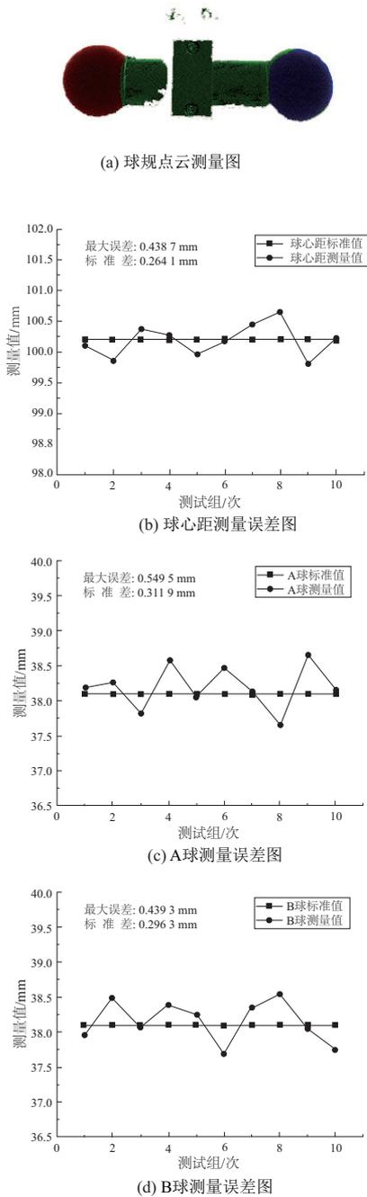
图 6 线激光相机测量误差图
