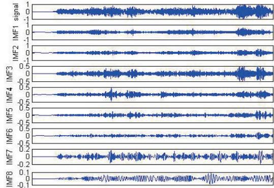
图 2 正常脱模的原始信号与分解后的前 8 个 IMF
