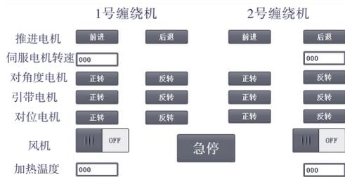
图 11 手动模式 HMI 界面
