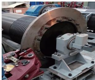
图 1 ZK514 型卷筒制动盘
