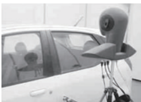
图2 车门声品质系统评价示意图
