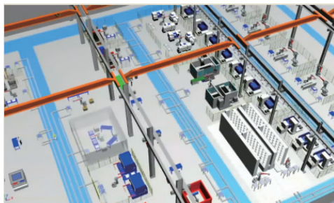
图4 工艺流程及布局数字化建模
