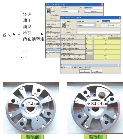
图 13 整改前后定子变化对比图
