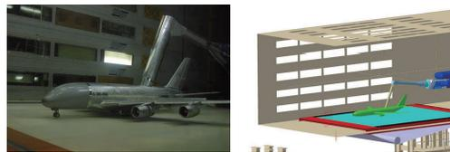
图 1 有无移动带地板风洞试验示意图
