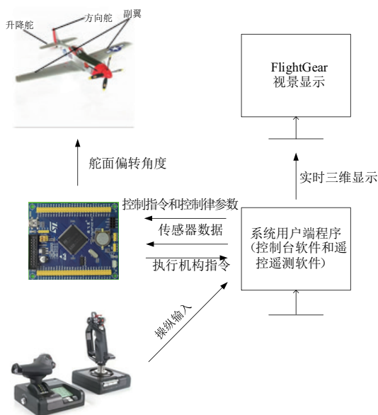
图 1 半实物飞行控制实验平台结构图
