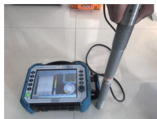
(b) 螺栓拆卸后验证
