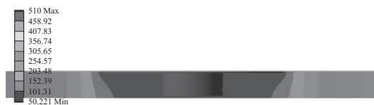
图2 搅拌摩擦焊温度场仿真(轴肩 25 mm)
