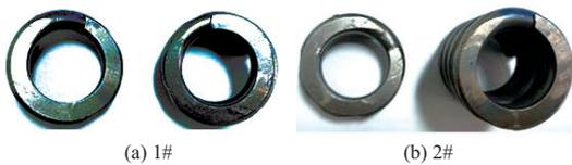
图6 弹簧失效件底面形貌
