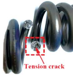
图3 1#弹簧断口宏观形貌
