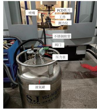
图 3 低温液氮冷却系统
