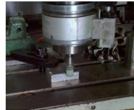
图5 旋转超声磨削加工
