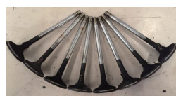
图8 试验后进气门图片
