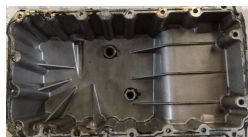
图7 试验后油底壳图片
