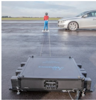
图 12 AEB 行人检测系统 联动测试
