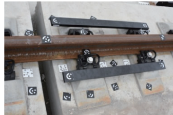
图5 铁路现场摄站布置
