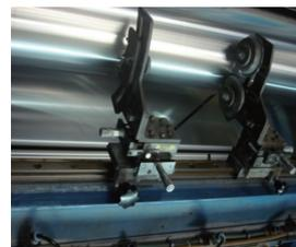
图 1 铝箔剪切机分切流程设备
