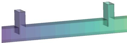
图7 2个挡板管路模型
