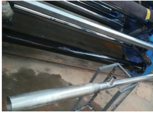
图2 碎屑收集管样品
