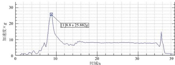
图 8 某型起动机振动谱线(时域-加速度)
