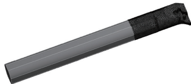
图 4 ANSYS Workbench 中的刀杆刚柔耦合模型
