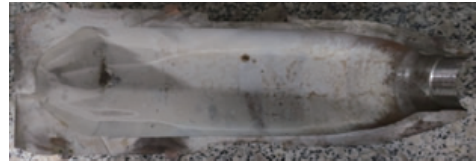
图 12 某型榴弹完成内膛圆柱部机加工工序的切割弹
