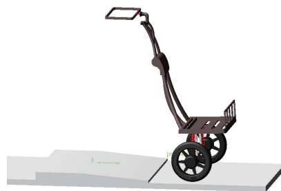
图5 单兵携行装置多刚体动力学模型
