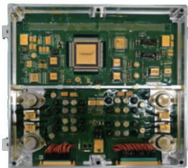
图8 帆板驱动控制器实物图
