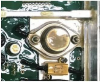
图7 大器件加固方法示意图
