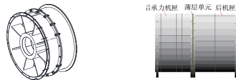
(a) 后承力机匣和后机匣组合件 (b) 组合件连接结构简化建模
