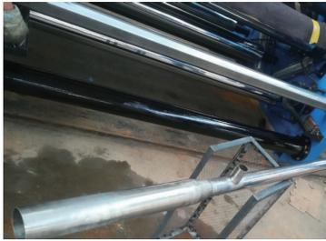
图1 铝箔碎屑收集负压管样品
