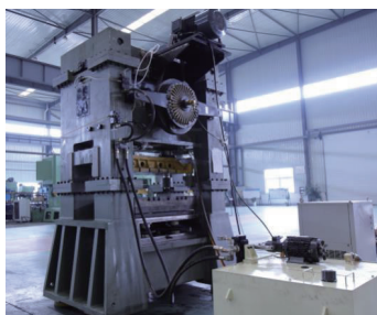
图 13 闭式多杆超高速精密数控冲床产品样机
