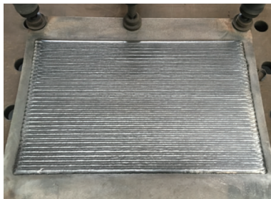
图11 高氮钢-不锈钢单层多道成型情况
