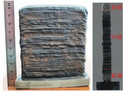
图 2 单墙体纵向截面宏观形貌 Fig. 2 Macro-graph of as-fabricated parts
