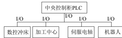
图 1 中央控制柜 PLC 通信连接
