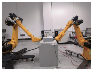
图6 双机器人协调搬运实验
