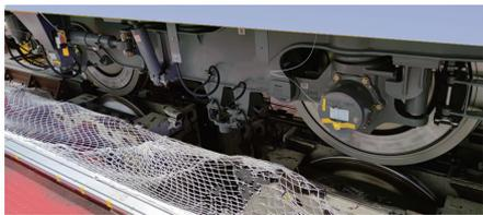
图2 转向架于滚振试验台现场试验图
