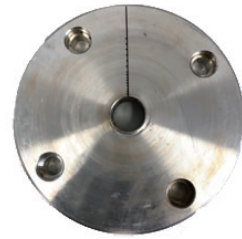
图 6 冷挤压预处理工件图
