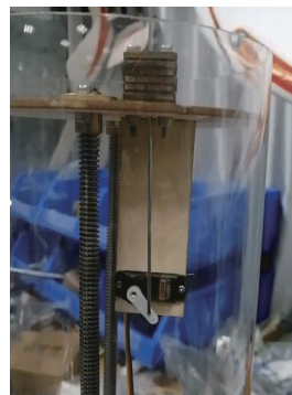
图 5 利用舵机控制绳套的展开
